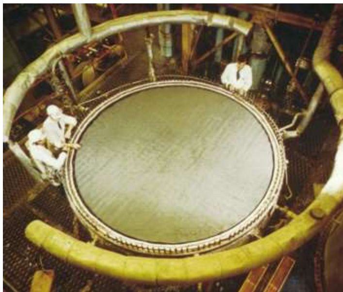
Pt-Rh catalizador usado en el proceso Ostwald
